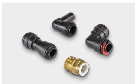
Für die Ausführung von Verbindungen der Soffio-Heizplatten können handelsübliche PushFit-Stecksysteme der Fa. Geberit verwendet werden. Direkt nebeneinander angereihte Soffio-Heizplatten werden mit einer PushFit-Kupplung verbunden. Der Anschluss an die Wasseranlage erfolgt mit einer PushFit-Anschlussverschraubung mit Außengewinde G 1/2 1/2".
