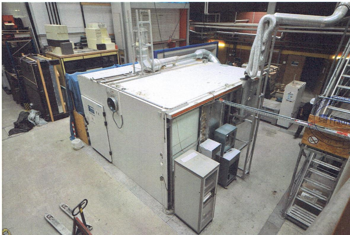
Abbildung 2: Technische Versuchseinrichtung (Kalorimeterraum) zur Bestimmung von Energiebilanzen.
